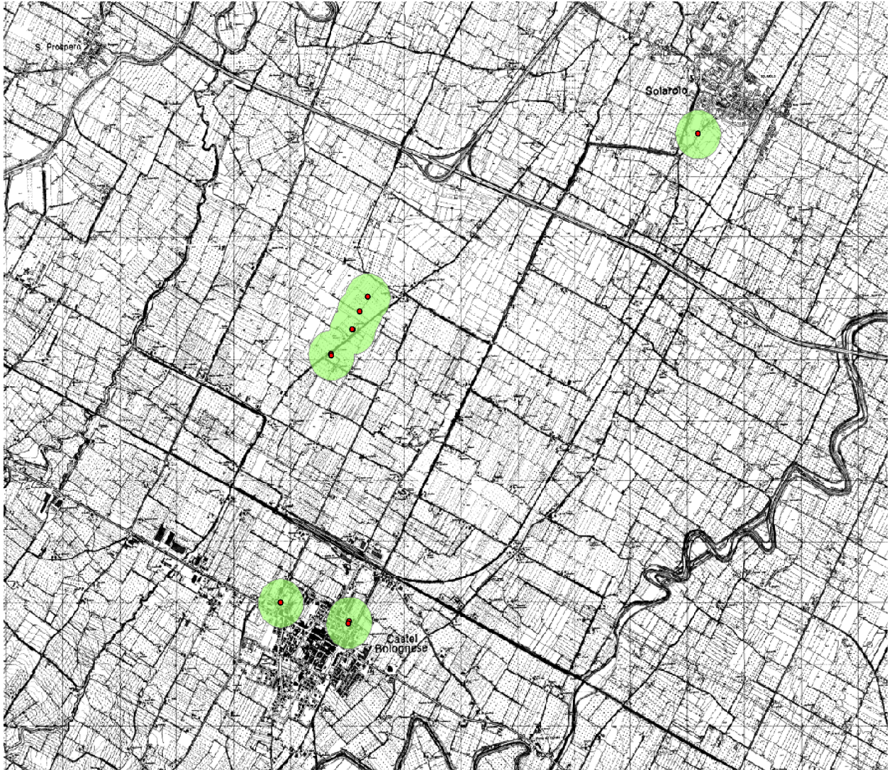
Figura 1 – 79 Zone di rispetto dei pozzi idropotabili nei comuni di CastelBolognese e Solarolo (in verde).
